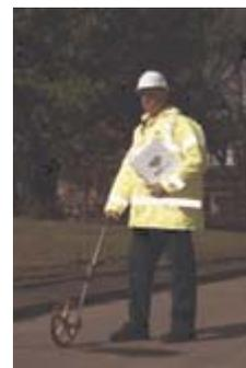
GE-M10-111 Rueda de medir (odómetro) de precisión. Con maletín.
