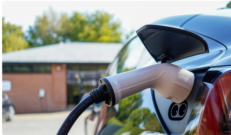
Toma de carga CCS COMBO 2 de un coche eléctrico con conector Tipo 2 conectado.
