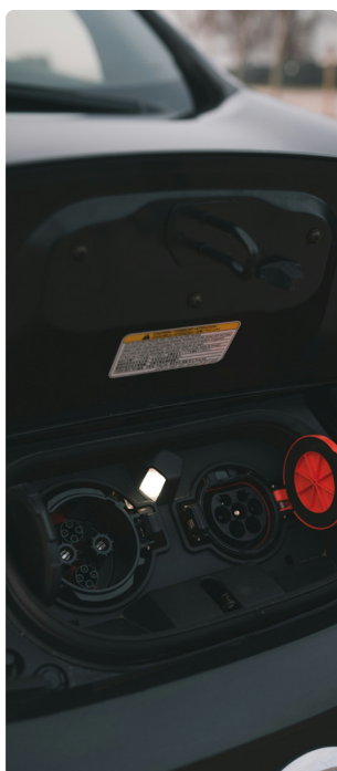
Toma de carga de un vehículo para conectores CHAdeMO y Tipo 2.
