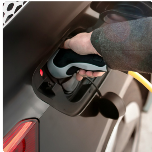
Toma de carga de un coche eléctrico con conector Tipo 2.
