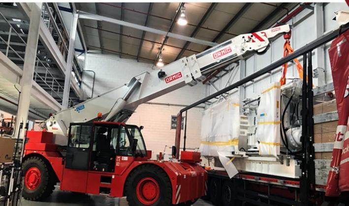
Gama de autogrúas con chasis autoportante y sin estabilizadores que permite la circulación del vehículo con la carga suspendida, lo que les confiere gran agilidad para desplazarse con o sin carga tanto en exteriores como recintos cerrados.
