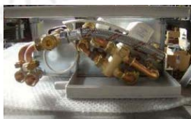
Kit hidráulico montado y cableado
